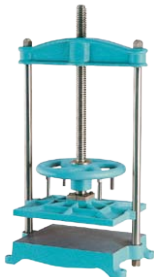
M-PRESS S Pressa manuale di medio formato, per l'incassatura manuale di libri ed agende e per altri lavori di legatoria
